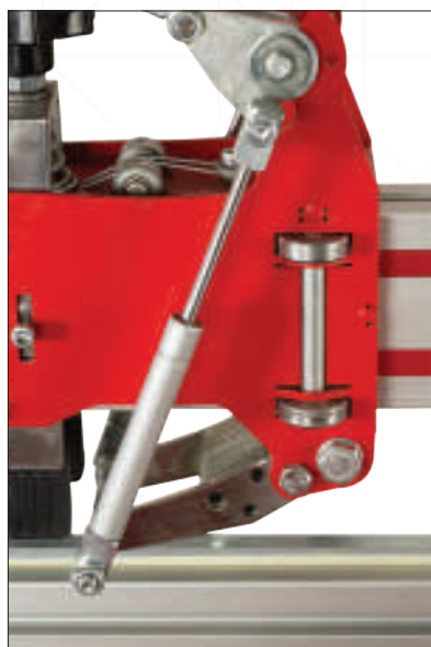
Система газового амортизатора для постоянного давления.
