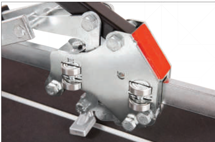
Механизм рычага состоит из 11 скрытых шарикоподшипников.
