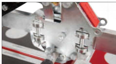
Механизм рычага состоит из 13 скрытых шарикоподшипников.
