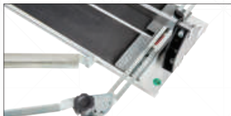
Имеются градуированные опора и линейка
