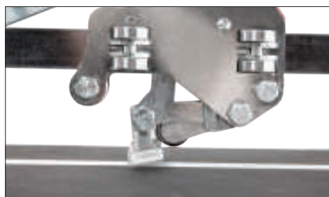
Резак с подшипником, используется с алмазом Ø 22 мм
