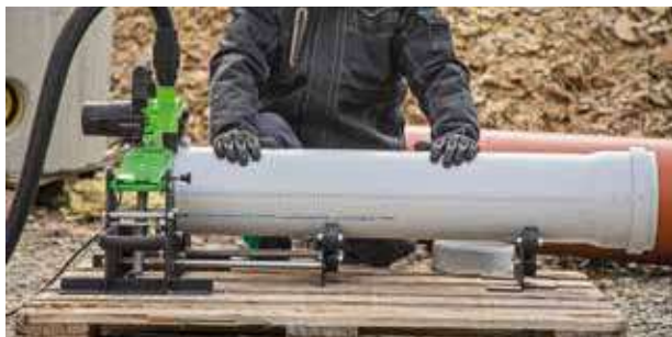
Rohr horizontal und vertikal exakt zum Sägeblatt ausrichten
