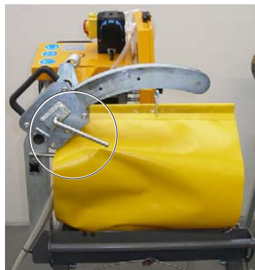
Рис. 4.33, Салазки режущего рукава установлены в положение угла наклона 0^\circ
