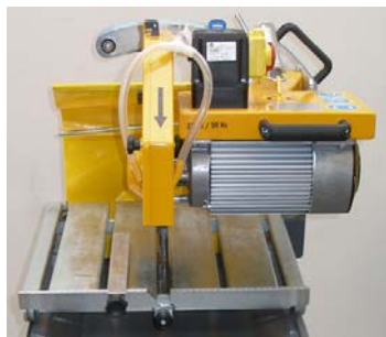
Рис. 4.34, Салазки режущего рукава установлены в положение угла наклона 0^\circ
