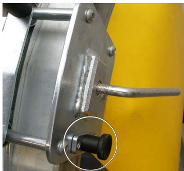
Рис. 4.30, зажимной рычаг вверх, фиксатор на салазках зашелкнут
