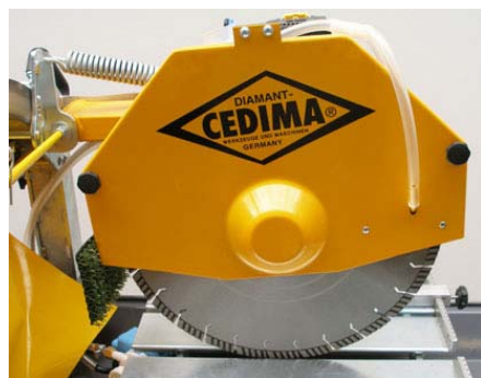
Рис. 4.25, Режущий диск смонтирован, крышка защитного кожуха диска закрыта
