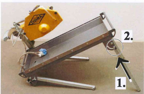
Рис. 4.6, CTS • 57 G устанавливается
