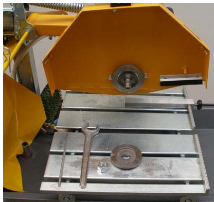
Рис. 4.20, Гайка режущего вала и прижимной фланец диска сняты
