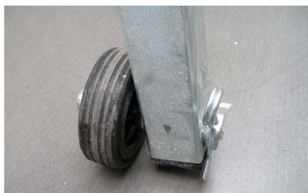
Рис. 5.4, CTS • 57 G, на опорной ножке смонтирован транспортный ролик
