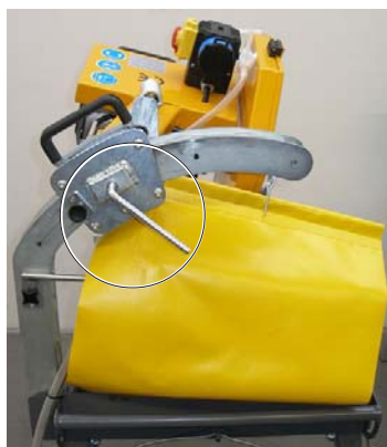
Рис. 4.35, Салазки режущего рукава установлены в положение угла наклона 15^\circ
