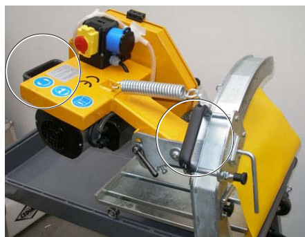
Рис. 4.29, Салазки режущего рукава с обеими ручками для наклона на желаемый угол
