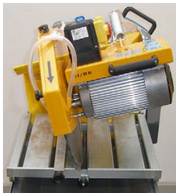
Рис. 4.36, Салазки режущего рукава установлены в положение угла наклона 15^\circ
