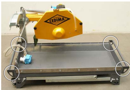
Рис. 5.9, CTS • 57 G, отверстия на трубах рукоятках, опорные ножки сложены, роликовый стол снят
