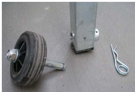
Рис. 5.3, CTS • 57 G, транспортный ролик снят с опорной ножки
