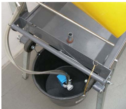
Рис. 4.14, Водяной насос в ведре, сливная трубка в ванне
