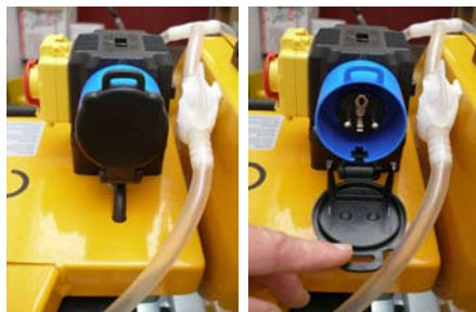
Рис. 4.37. Сетевой кабель с штекером 230 В, слева крышка закрыта, справа открыта
