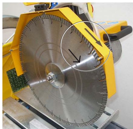
Рис. 4.24, Алмазный диск смонтирован, направление вращения режущего вала и режущего диска
