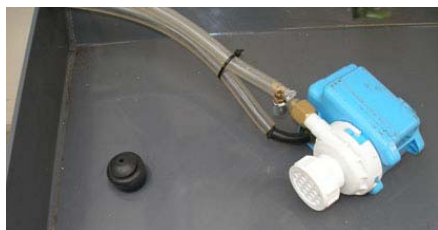
Рис. 4.13, водяной насос, резиновая заглушка в водяной ванне
