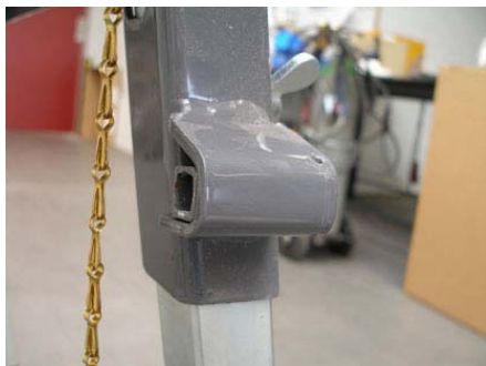
Рис. 5.6, CTS • 57 G, крепление ролика на раме настольной пилы, транспортный ролик снят
