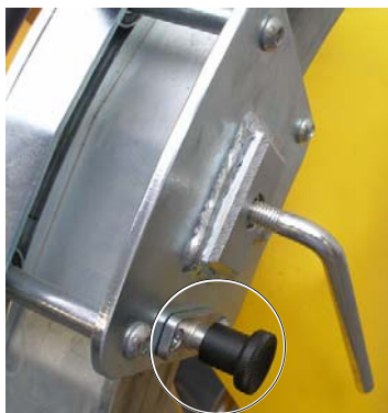
Рис. 4.31, зажимной рычаг вверх, фиксатор на салазках вынут (не функционирует)
