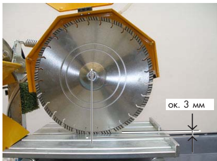
Рис. 4.27, Режущий рукав (режущий диск опущен на полную глубину резки)
