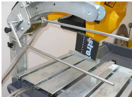
Рис. 4.11, держатель брызговика смонтирован
